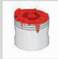
An- und Abschmelzungen am Kolbenkopf (Dieselmotor)
