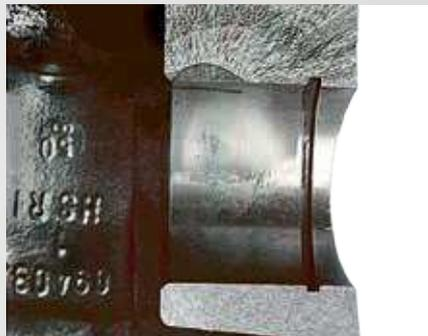
Abb. 3 Querschnitt einer Kolbenbolzennabe
