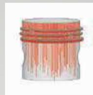
Verschleiß der Kolben, Kolbenringe und Zylinderlaufbahn durch Schmutz 78
