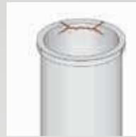
Zylinderlaufbuchsenriss durch Flüssigkeitsschlag **74**
