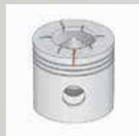
Kolbenboden- und Muldenrisse (Dieselmotor)
