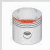
Erosion am Feuersteg und auf dem Kolbenboden (Ottomotor)
