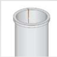
Längsrisse in der Zylinderlaufbuchse **65**
