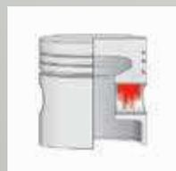
Fresser in den Kolbenbolzen-naben (Schrumpfleuel)
