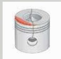
Kolbenbruch durch Anlauf des Kolbenbodens gegen den Zylinderkopf
