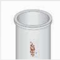
Kavitation an Zylinderlaufbuchsen **68**
