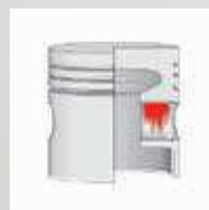
Fresser in den Kolbenbolzen-naben (schwimmend gelagerter Kolbenbolzen)
