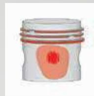
Verschleiß der Kolben, Kolbenringe und Zylinder durch Kraftstoffüberschwemmung 80
