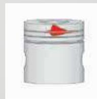
Materialauswaschung in der Kolbenringzone (Kolbenringbruch) 50
