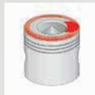
Anschlagspuren am Kolbenkopf (Dieselmotor)
