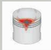
Abschmelzungen von Kolbenkopf und Kolbenschaft (Ottomotor)
