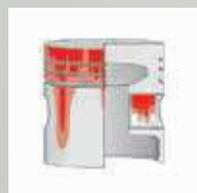
Fresser in den Kolbenbolzen-naben (mit Kolbenschaftfresser)
