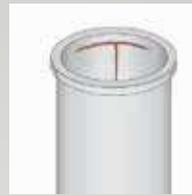
Abgerissener Buchsenbund an der Zylinderlaufbuchse (Vorstufe) **66**
