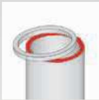
Abgerissener Buchsenbund an der Zylinderlaufbuchse **66**
